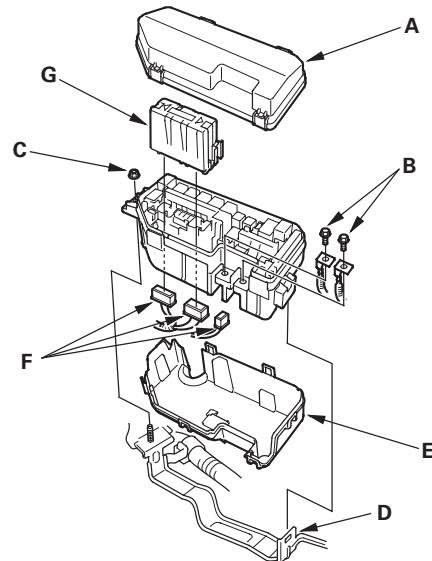
3. 拆下螺母 (C) 并松开凸舌 (D)，然后将底盖 (E) 从发动机盖下保险丝 / 继电器盒上拆下。
